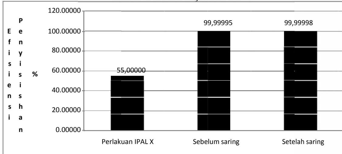
Gambar 3 menunjukkan bahwa terjadi penurunan konsentrasi TSS yang telah diolah. Hasil pengolahan limbah domestik dengan biokoagulan menunjukkan bahwa parameter pencemar TSS turun dari kondisi awal 200 mg/L menjadi 0,000107 mg/L dengan efisiensi penyisihan sebesar 99,99995% (sebelum saring). Pengolahan IPAL X mampu menyisihkan TSS sebesar 55%. Hal tersebut menunjukkan bahwa biokoagulan lebih efisien 44,99995% dibandingkan dengan hasil pengolahan IPAL X.
